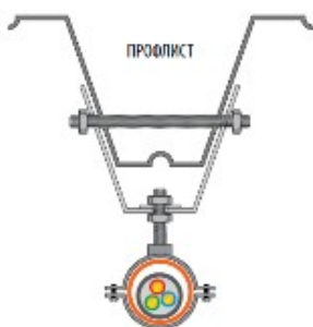
Рисунок 15 - Монтаж ОКЛ в обхват горизонтальных металлических конструкций
