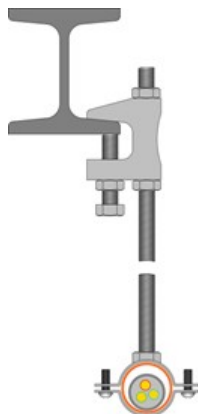
Рисунок 17 - Монтаж ОКЛ к металлическим несущим конструкциям, металлической балке, балке двутавровой, металлическому профилю, уголку
