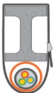
Рисунок 15 - Монтаж ОКЛ в обхват горизонтальных металлических конструкций
