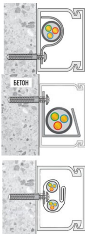
Рисунок 18 - Монтаж ОКЛ в кабельном канале при помощи дюбеля и самореза к поверхности из кирпича/бетона
