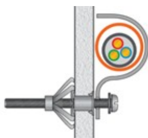
Рисунок 11 - Монтаж ОКЛ при помощи резьбовой заклепки и винта к поверхности из сэндвич-панелей
