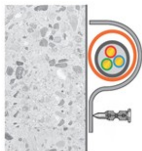
Рисунок 10 - Монтаж ОКЛ при помощи дюбель-гвоздя для газового монтажного пистолета к поверхности из кирпича/бетона
