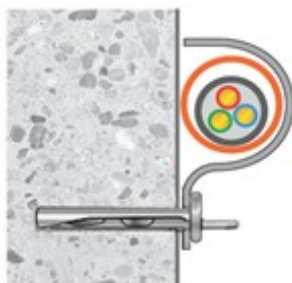
Рисунок 8 - Монтаж ОКЛ при помощи дюбеля и самореза к поверхности из кирпича/бетона
